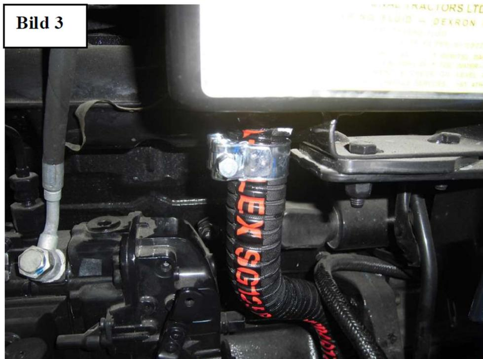
9. Saugschlauch mit mitgeliefertem Halter mit original Schraube befestigen. (Bild4)
