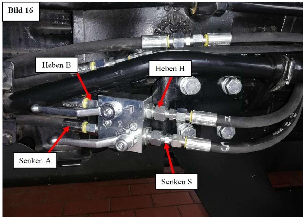
23. Hydraulikschläuche vom Absperrhahn, oder Umschaltventil nach hinten verlegen und an original Steuergeräte anschließen.
